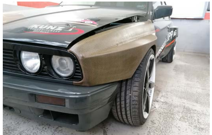
Der 2019 präsentierte Kunststoffverbundwerkstoff eignet sich zur Herstellung von superleichten Carrosserieteilen für den Rennsport.
